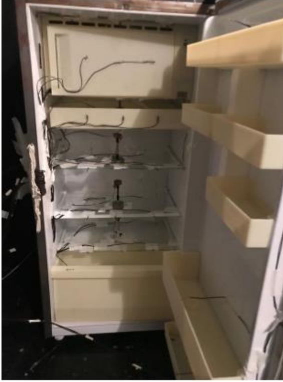
Şekil 3: Prototip üzerinde ısıtıcı çiftlerin ve pirinç blokların yerleşimi
